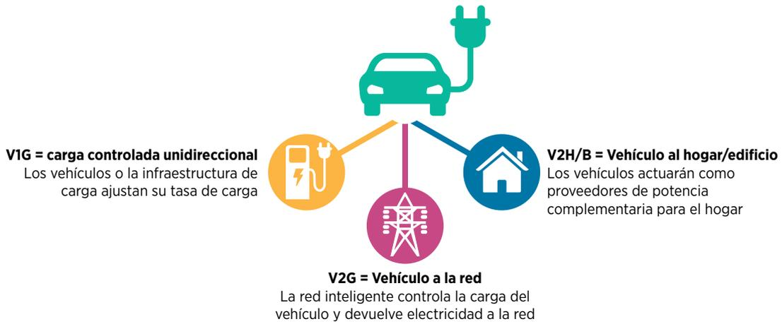
Figura S3: La carga inteligente permite a los VE proporcionar flexibilidad
